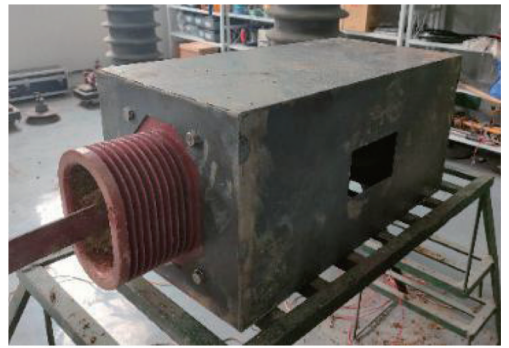
图 2 “棒-棒”电极间隙放电模型箱
