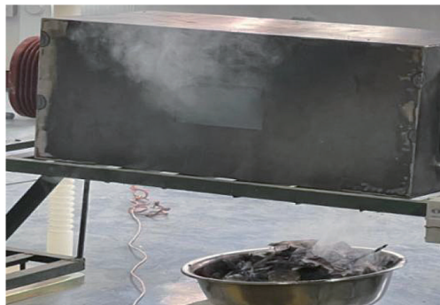
图 5 间隙烟雾试验
