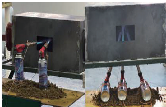
图 3 密闭和半密闭状态下加热试验
