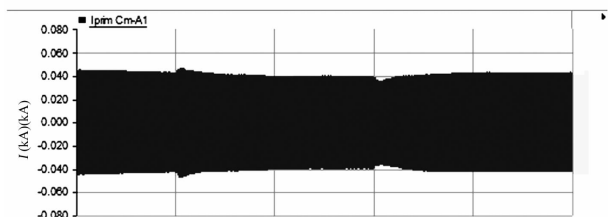
图 9 V_{ref} 的 k = 1000 \text{ V/s} 时仿真波形
