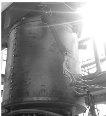
图 4 特制的电流互感器箱体
