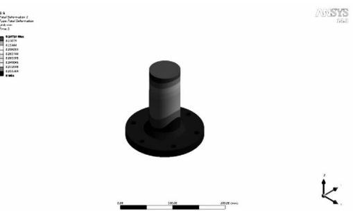
图12 接线柱变形云图(“一”字型)
