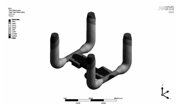
图 10 “一”字型结构整体变形云图
