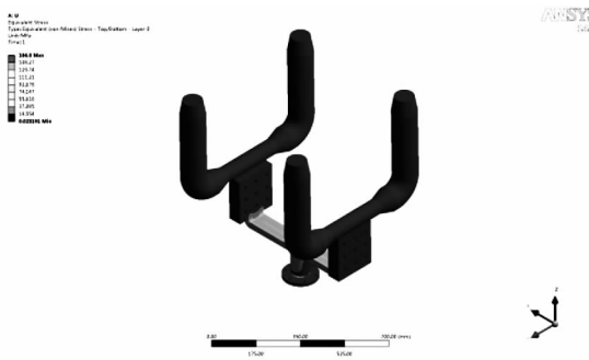
图 6 “U”型结构整体应力云图
