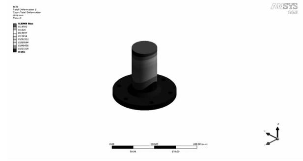
图 7 接线柱变形云图(“U”型)
