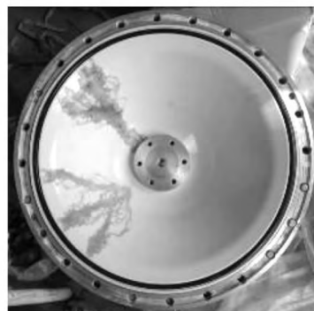
图7 50212 隔离开关盆式绝缘子沿面闪络
