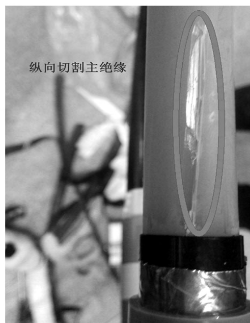
图 8 主绝缘割伤(纵向切割)
