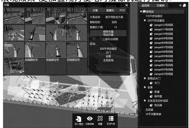
图2 摄像机安装方案实景展示图
