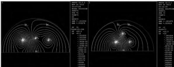
(a) 水平排列导线磁力线分布云图 (b) 三角排列导线磁力线分布云图
