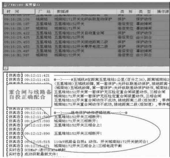
图7 线路备自投与线路重合闸动作结果图
