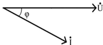
图 5 单相电能表接线向量图
