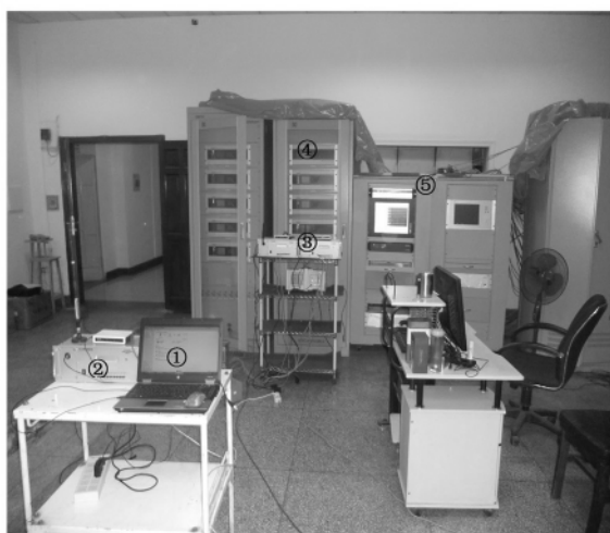
①软件平台②主硬件平台③2套从硬件平台 ④合并单元⑤数字录波器 图 5 模拟现场实验
